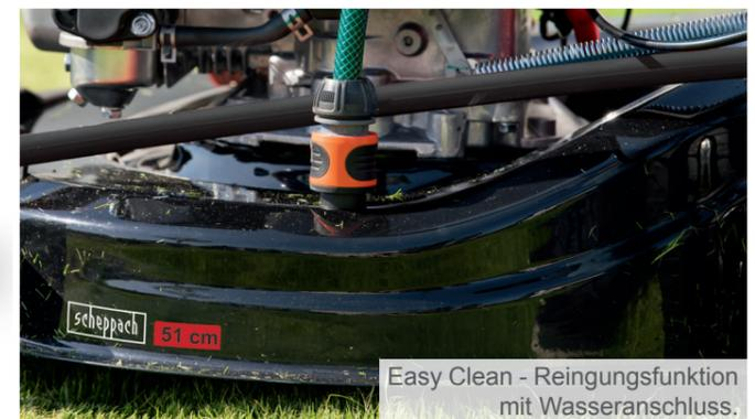
Easy Clean - Reinigungsfunktion mit Wasseranschluss.
