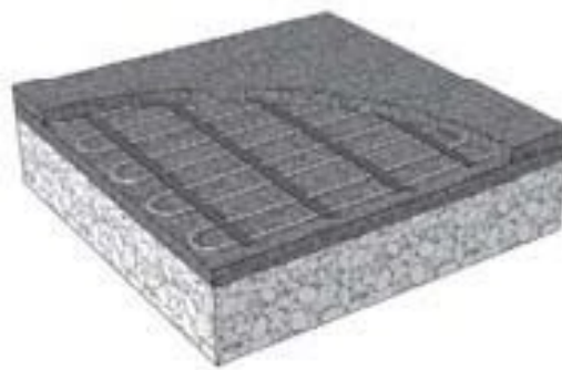
Kabel MA ICE-30 w asfalcie
