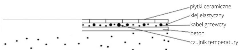
Rysunek 2: Bezpośrednio na betonie
