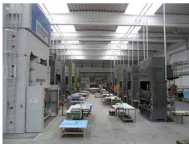
Linie produkcyjne elementów tłoczonych z GFK
