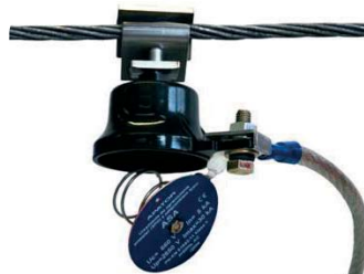
ogranicznik ASA z odłącznikiem po zadziałaniu (uszkodzeniu warystora)
