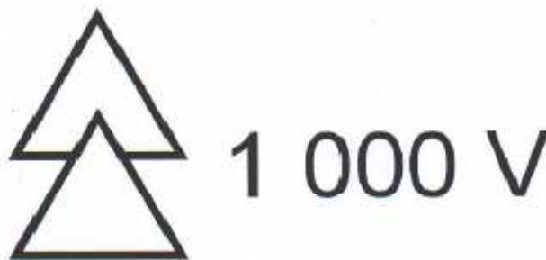
Rys. 8 Symbol IEC-60417-5216 (DB:2002-10) - Odpowiedni do prac pod napięciem podwójny trójkąt i oznaczenie napięcia
