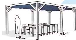
Elementy drewniane Pergola wolnostojąca (słupki: 6 szt., boki: 6 szt., zastrzały: 12 szt.)
