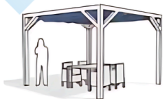
Elementy drewniane Pergola wolnostojąca (słupki: 4 szt., boki: 4 szt., zastrzały: 8 szt.)
